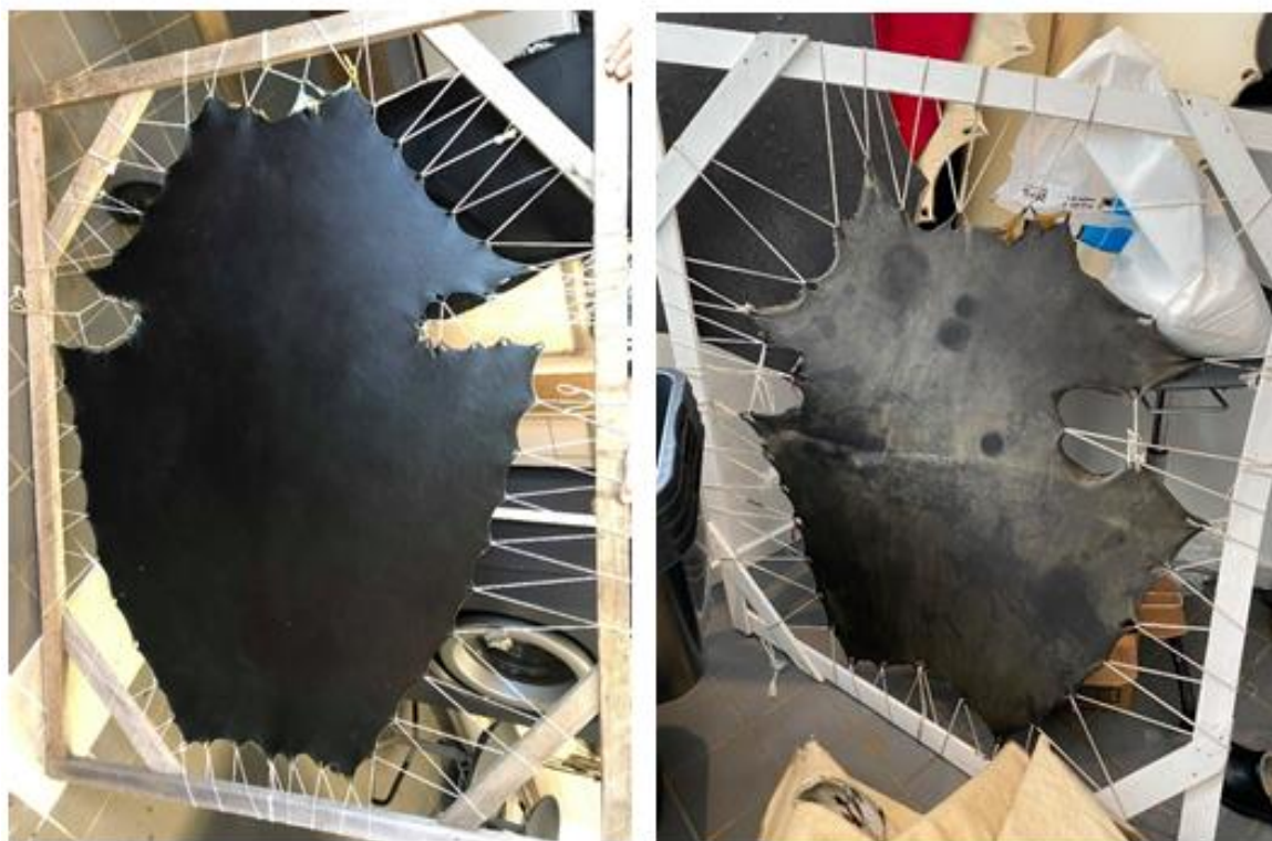
Fig. 30: Et billedkombination der viser forskellen af affarvning med tekstilfarve på to forskellige sælarter.
